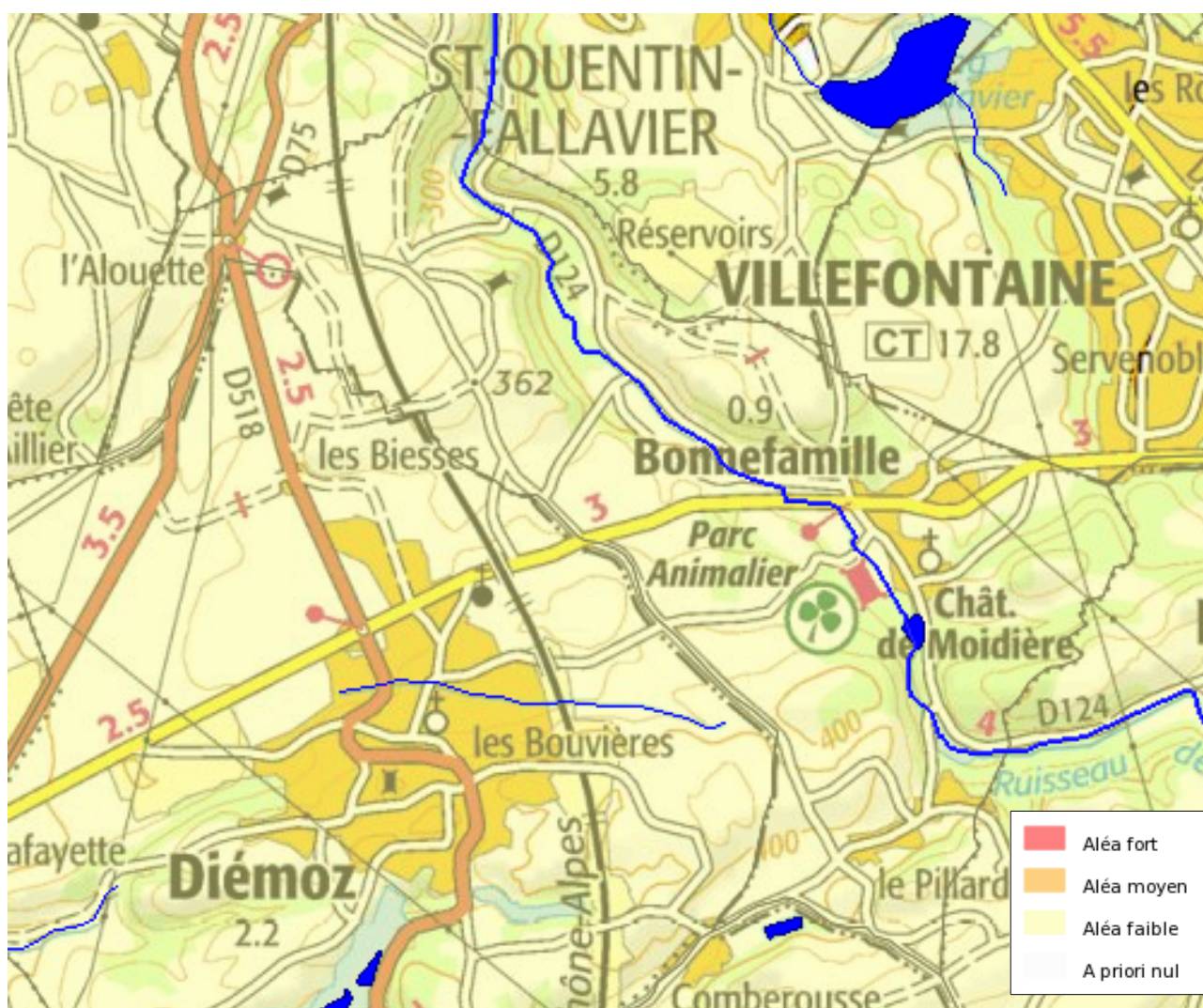
Figure V.1: Carte de l'aléa retrait-gonflement des sols argileux au niveau de la commune de Bonnefamille ( www.georisques.gouv.fr ).
