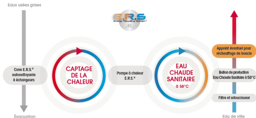
Figure 28 – Principe de fonctionnement de la PAC sur eaux grises – Source : Biofluides
