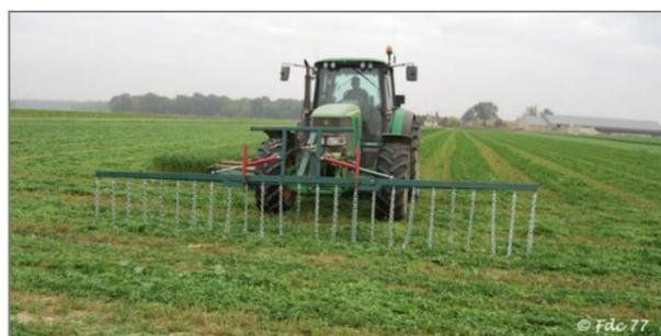
Figure 44 : Tracteur équipé de barres d'effarouchement
