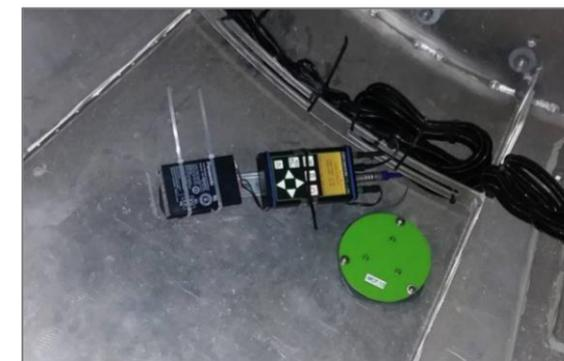
Figure 55 : Exemple de positionnement du dispositif d'écoute en nacelle
