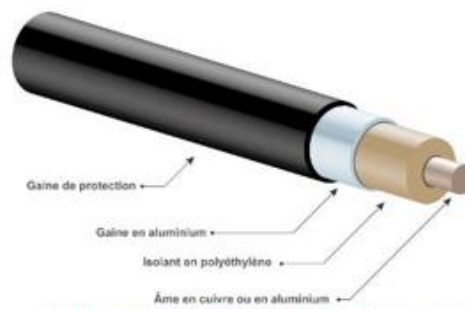
Schéma et constitution d'un câble souterrain (Source RTE)
