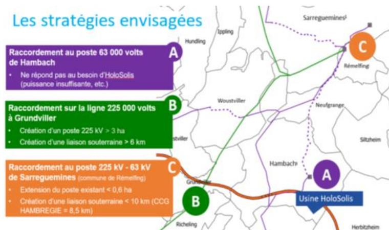
Figure 5 : Stratégies de raccordement et tracé des lignes électriques correspondantes (source : dossier)
