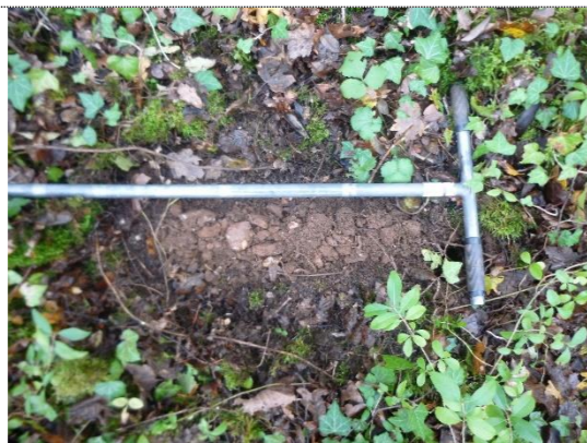
Photo du sondage pédologique N°2. Horizon supérieur argilo-limoneux grumeleux et peu compact sur les premiers 45 cm, puis argileux et compact. Charge en cailloux peu importante en haut de profil, s'accroissant fortement et constituant un refus de tarière à 50 cm. Aucune trace de traits rédoxiques sur l'ensemble du profil. Profondeur du sondage : 50 cm. Sol pouvant être rattaché à la classe III du référentiel GEPPA, non humide au titre de l'arrêté du 01 octobre 2009.
