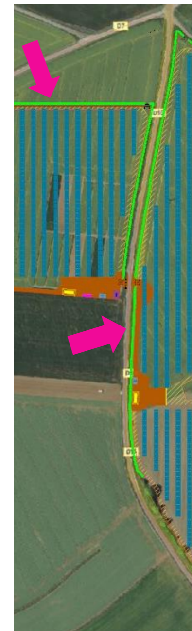
Implantation après prise en compte de l'enjeu paysager depuis la D7 et D16 (implantation de plusieurs haies (en vert))
