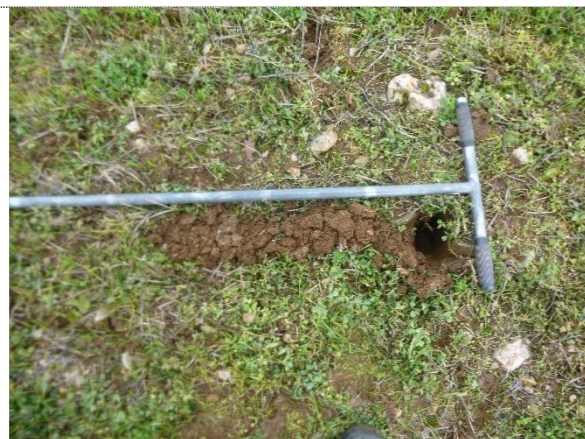
Photo du sondage pédologique N°8 Horizon supérieur argilo-limoneux grumeleux et peu compact sur les premiers 45 cm, puis très argileux et compact. Charge en cailloux très importante dès la surface s'accroissant en profondeur et constituant un refus de tarière à 50 cm. Aucune trace de traits rédoxiqes sur l'ensemble du profil. Profondeur du sondage : 50 cm. Sol pouvant être rattaché à la classe III du référentiel GEPPA, non humide au titre de l'arrêté du 01 octobre 2009.
