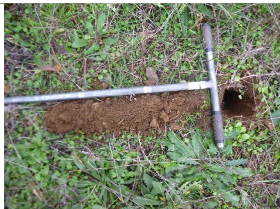
Photo du sondage pédologique N°1. Horizon supérieur argilo-limoneux grumeleux et peu compact sur la totalité du profil. Charge en cailloux très importante s'accroissant en profondeur. Aucune trace de traits rédoxiques sur l'ensemble du profil. Profondeur du sondage : 50 cm. Sol pouvant être rattaché à la classe III du référentiel GEPPA, non humide au titre de l'arrêté du 01 octobre 2009.
