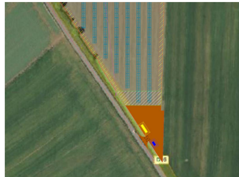
Base de vie n°2 : zone temporaire de grave concassée
