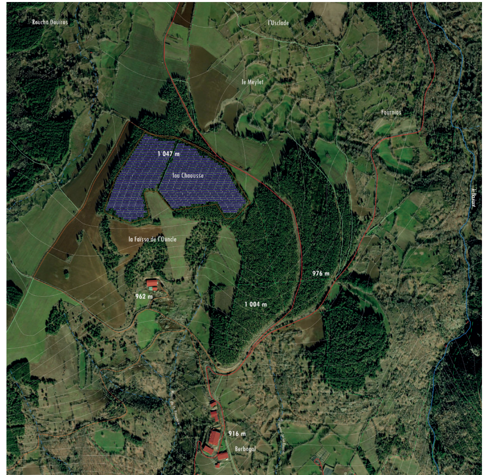
Carte n° 15 : Implantation finale des panneaux photovoltaïques
