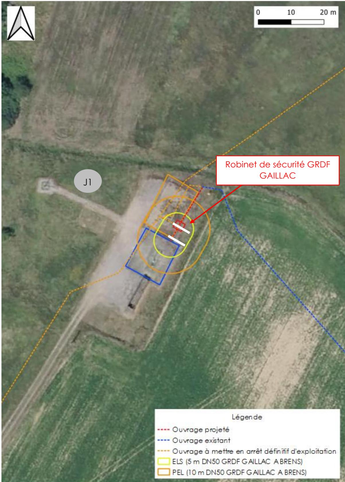
Figure 20 : Localisation des segments homogènes (Branchement DN50 GRDF GAILLAC A BRENS)
