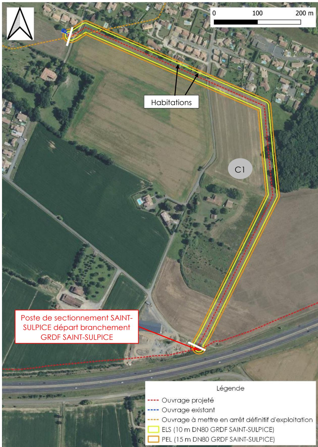
Figure 13 : Localisation des segments homogènes (Branchement DN80 GRDF SAINT-SULPICE)
