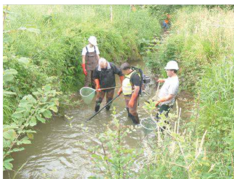
Figure 169 : Réalisation de l'opération à l'aide d'un appareil de pêche à l'électricité. Les poissons attrapés sont stockés dans un seau.
