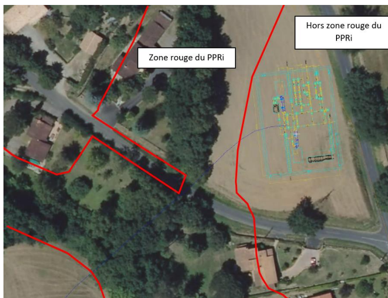
Figure 209 : Poste de sectionnement d'Albi hors PPRI
