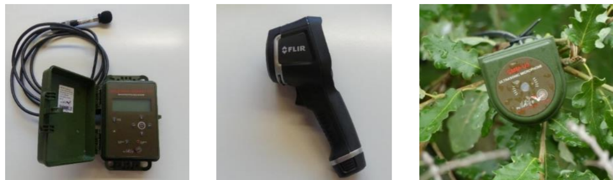
Enregistreur SM4 (gauche), caméra thermique FLIR (au centre) et micro U2 de SM4 (à droite)
