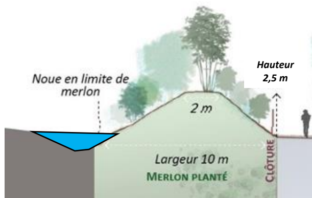
Illustration 92 : Détail de la noue Réalisation : ARTIFEX
