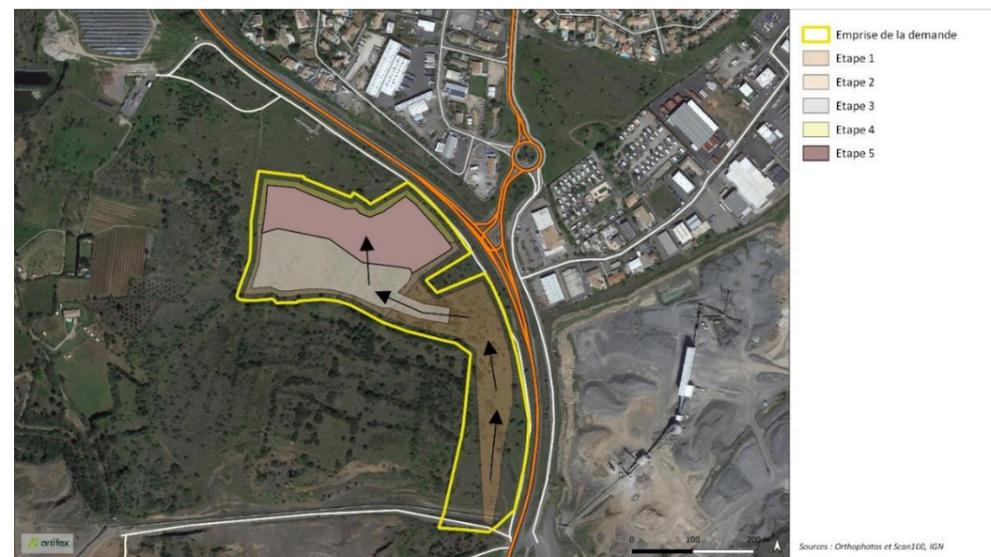
La phase de découverte a pour but le décapage des surfaces à exploiter. Elle génère un volume de terre végétale qui est utilisée pour la réalisation des merlons périphériques et la remise en état du site.
