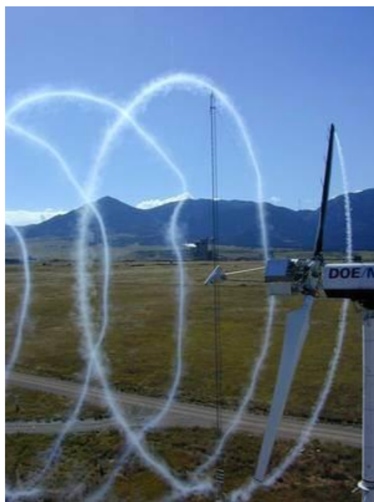
Figure 94 : Effet de sillage derrière une éolienne bi-pale visualisé à l'aide d'un traceur fumée (source : http://www.energieplus-lesite.be )
