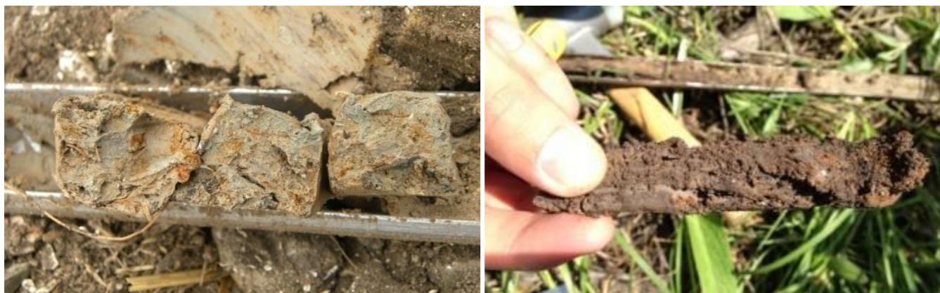
Taches de rouille et décoloration au sein d'un sol de zone humide
