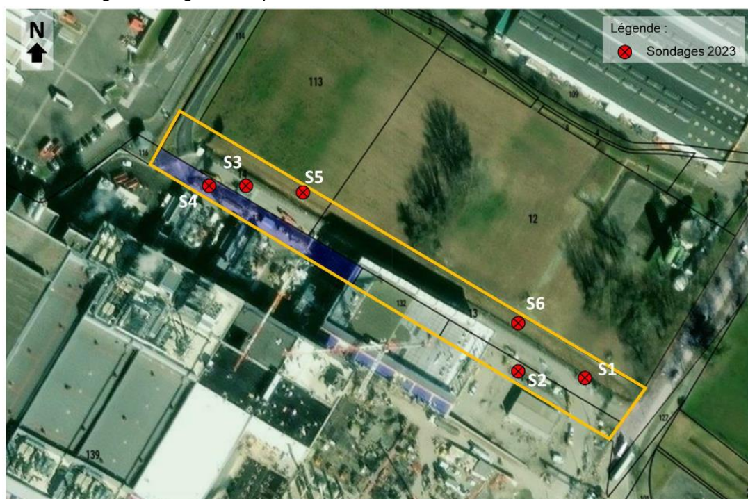
Figure 28 : Localisation de sondages réalisés par GINGER BURGEAP
