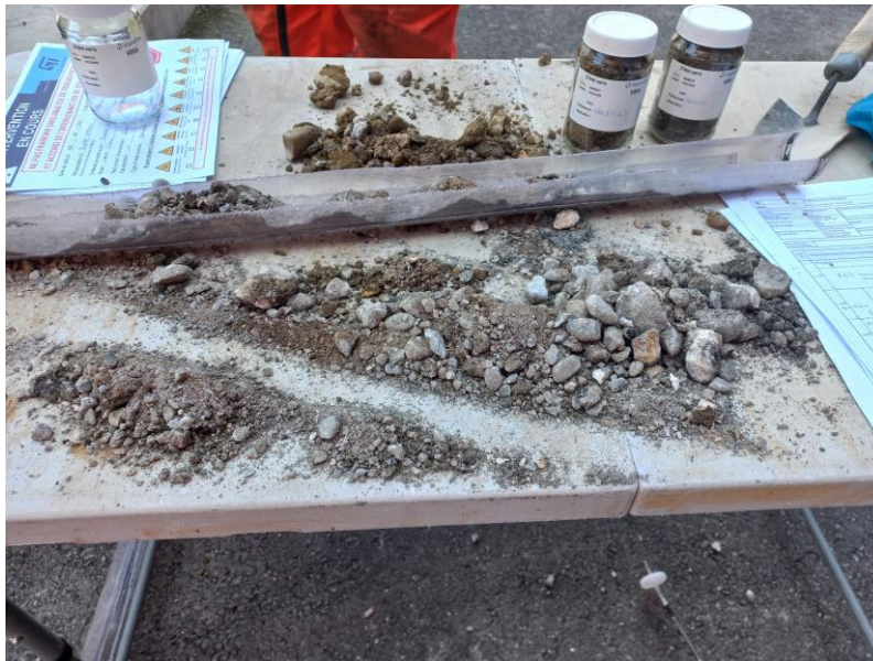
Figure 36 : matériaux contenus dans les gaines suite aux premiers forages
