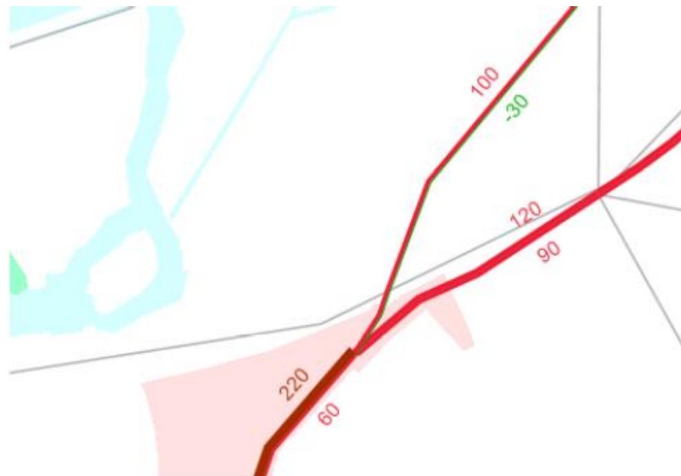
FIGURE 419 : ÉVOLUTION DES TRAFICS PREVUS ENTRE 2025 ET 2016 EN SITUATION DE REFERENCE (VEH/H) (SOURCE : ÉTUDE DE TRAFIC : TRAITEMENT DES PN AU NORD DE L'AGGLOMERATION, EGIS, 12/09/2016)
