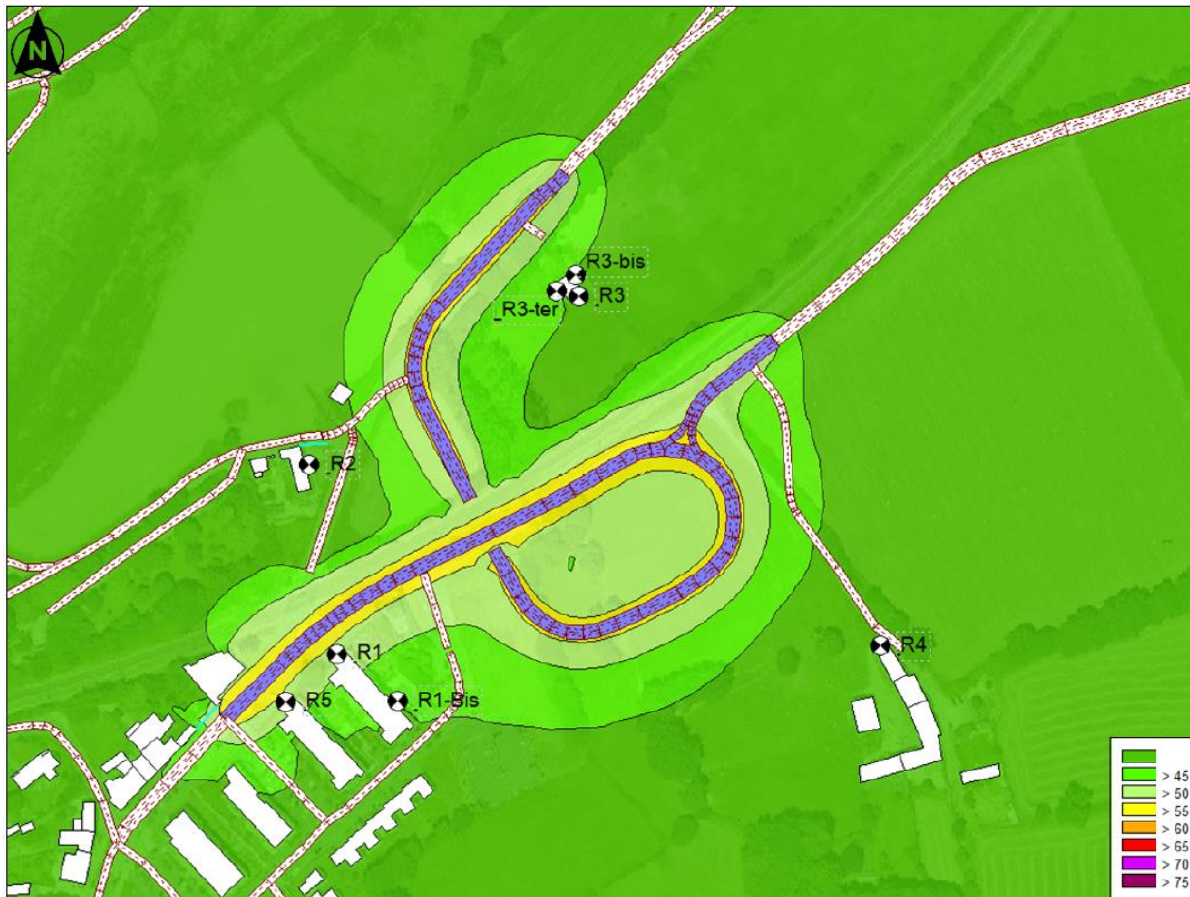
FIGURE 316 : CARTE ISOPHONE DETAILLANT L'IMPACT DU PROJET SEUL EN PERIODE NOCTURNE (22H-6H) (SOURCE : ÉTUDE D'IMPACT ACOUSTIQUE, SUPPRESSION DU PASSAGE A NIVEAU PN4, ACOUSTB, DECEMBRE 2021)
