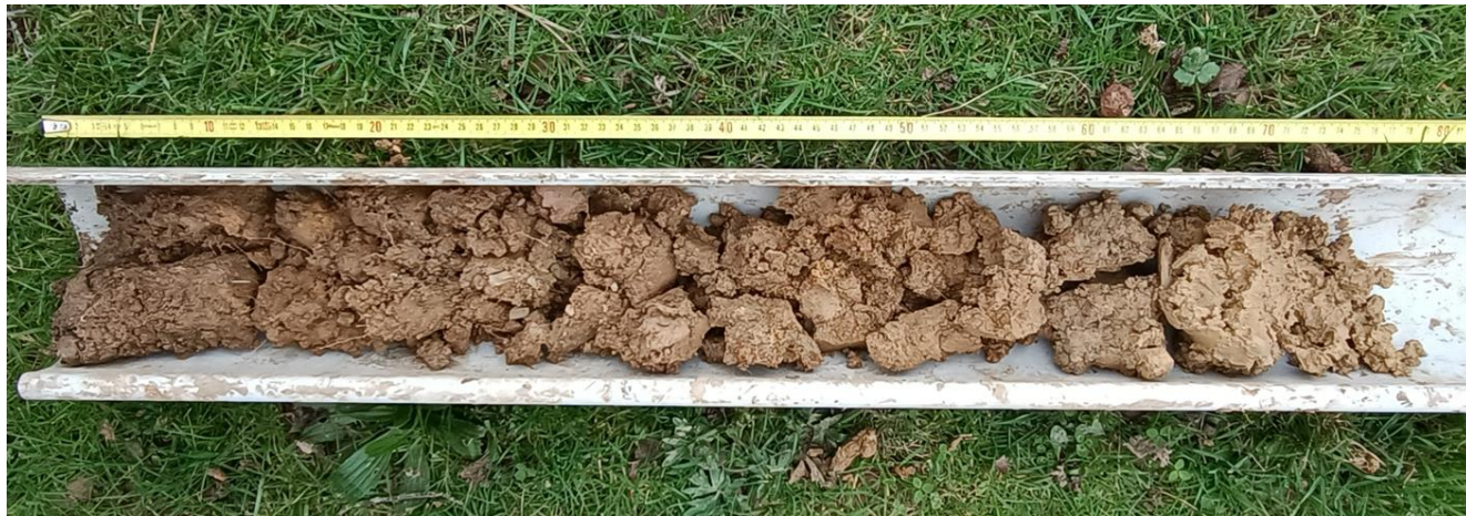
FIGURE 378 : CAROTTAGE D'UN SONDAGE (SOURCE : EGIS, FEVRIER 2024)
