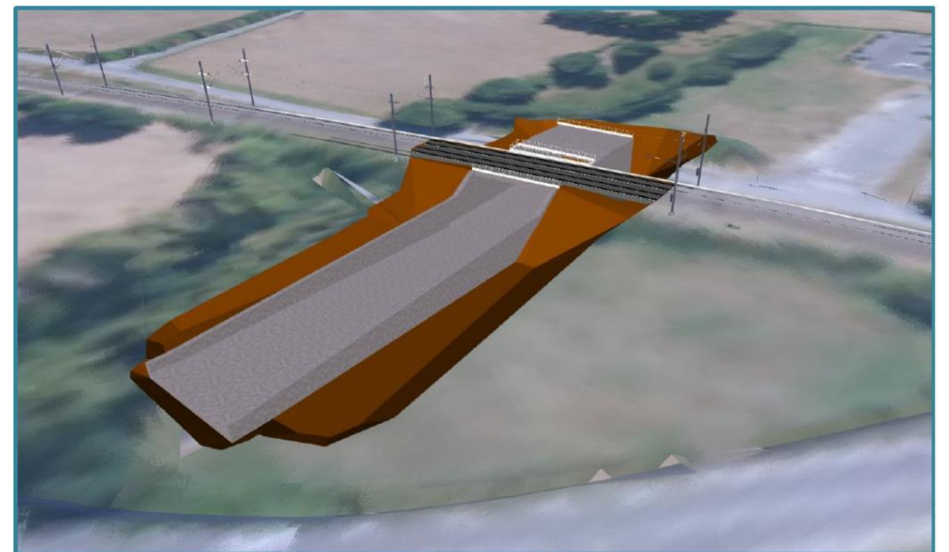
FIGURE 47 : MISE EN PLACE DU CUVELAGE DE LA RAMPE NORD (SOURCE : NOTICE TECHNIQUE AVP, SNCF RESEAU, 04/03/2022)
