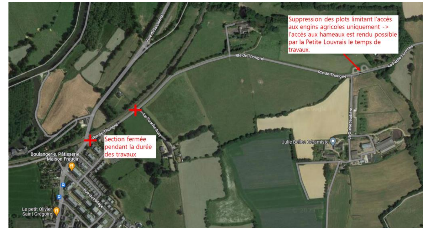
FIGURE 384 : ITINÉRAIRE DE DÉVIATION MIS EN PLACE PENDANT LA DURÉE DES TRAVAUX
