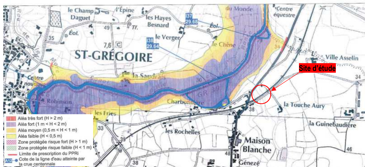
Figure 4 : Extrait de plan de zonage du PPRI du bassin de la Vilaine en région rennaise, Ile et Illet, Préfecture d'Ile et Vilaine
