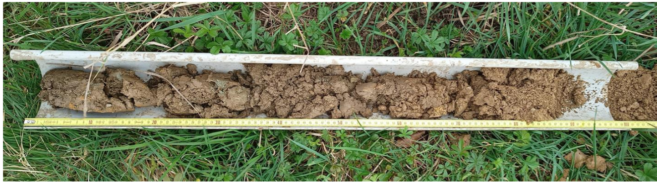
FIGURE 24 : CAROTTAGE D'UN SONDAGE PEDOLOGIQUE DU HAUT DE PARCELLE (SOURCE : EGIS, FEVRIER 2024)
