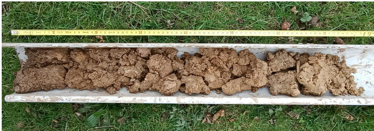
FIGURE 25 : CAROTTAGE D'UN SONDAGE PEDOLOGIQUE SUR LE CHEMIN EN BORDURE DE L'ETANG (SOURCE : EGIS, FEVRIER 2024)
