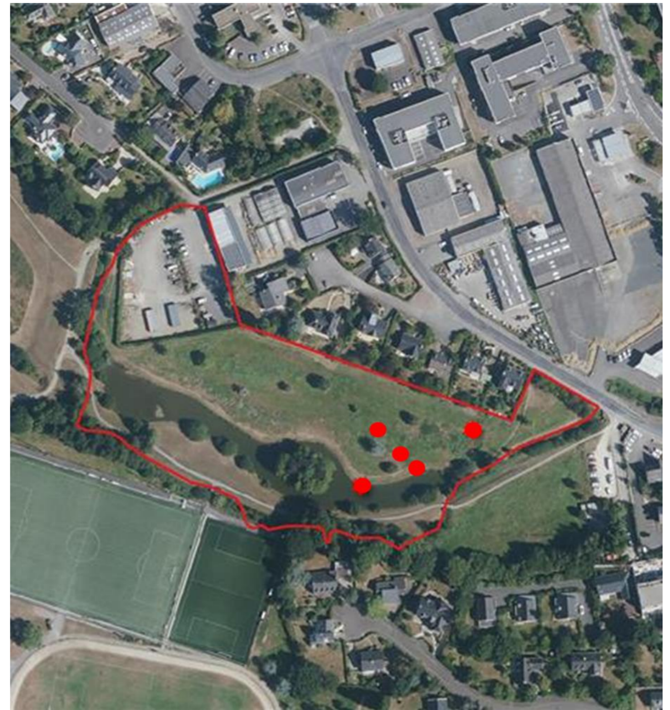
FIGURE 54 : LOCALISATION DES SONDRAGES PEDOLOGIQUES REALISES SUR LE SITE DE COMPENSATION PRESSENTIE DANS LE CADRE DU PROJET DE SUPPRESSION DU PN4 (SOURCE : EGIS, FEVRIER/AVRIL 2024)
