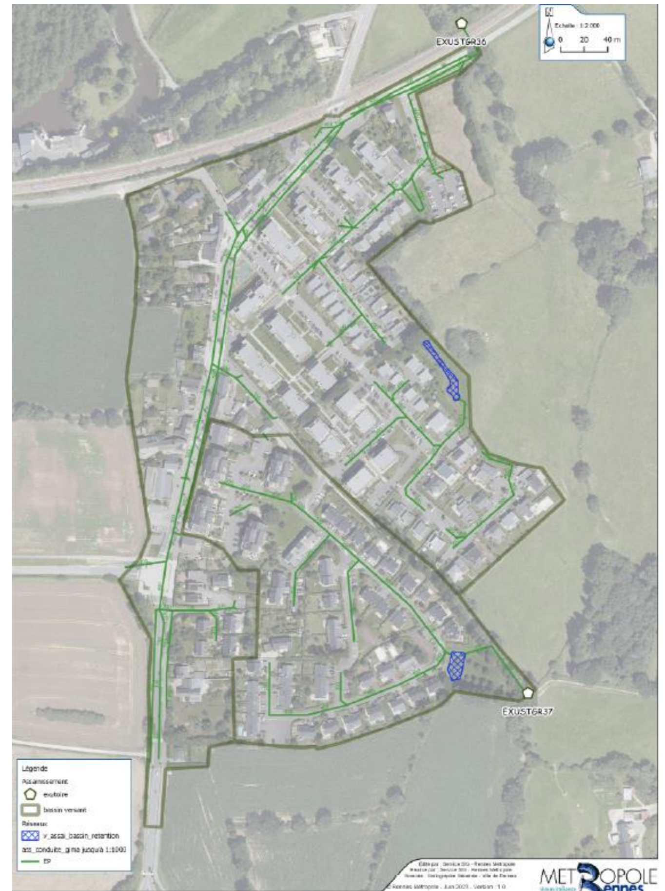
FIGURE 4 : DECOUPAGE DES BASSINS VERSANTS SUR MAISON BLANCHE - RESEAU EAUX PLUVIALES ET OUVRAGE DE RETENTION (SOURCE : RENNES METROPOLE, JUIN 2023)
