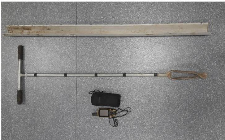
Figure 1 : Matériel utilisé pour réaliser les sondages pédologiques
