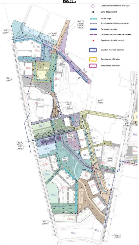
ANNEXE 3 : PLAN DE PRINCIPE DU FONCTIONNEMENT HYDRAULIQUE DU QUARTIER « CHÊNE DES ANGLAIS »
