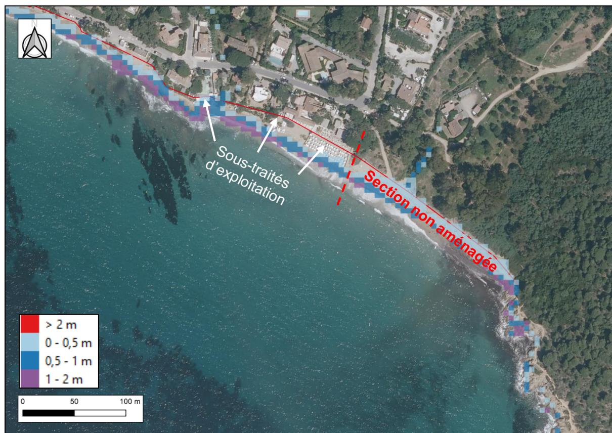
Figure 2 - Aléa submersion centennal à l'horizon 2100 (intégrant donc 60 cm de surcote).
