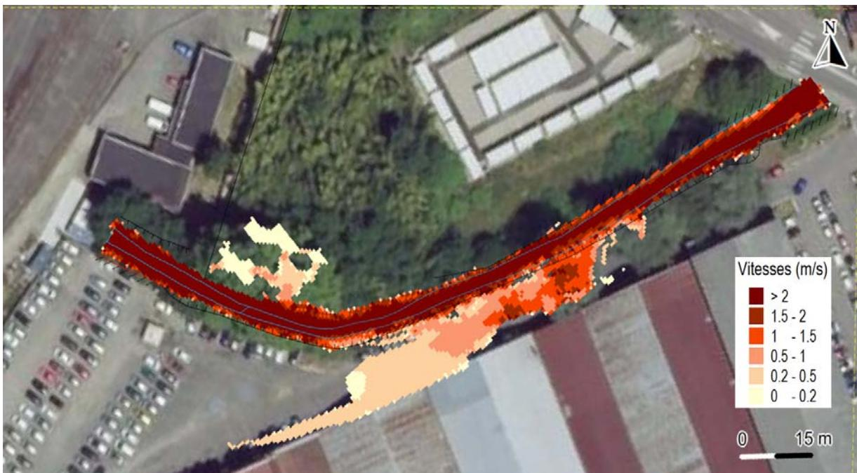
Figure 17 : Vitesses d'écoulement estimées en l'état actuel au niveau du projet de requalification – T = 10 ans (Q ~16 m3/s)
