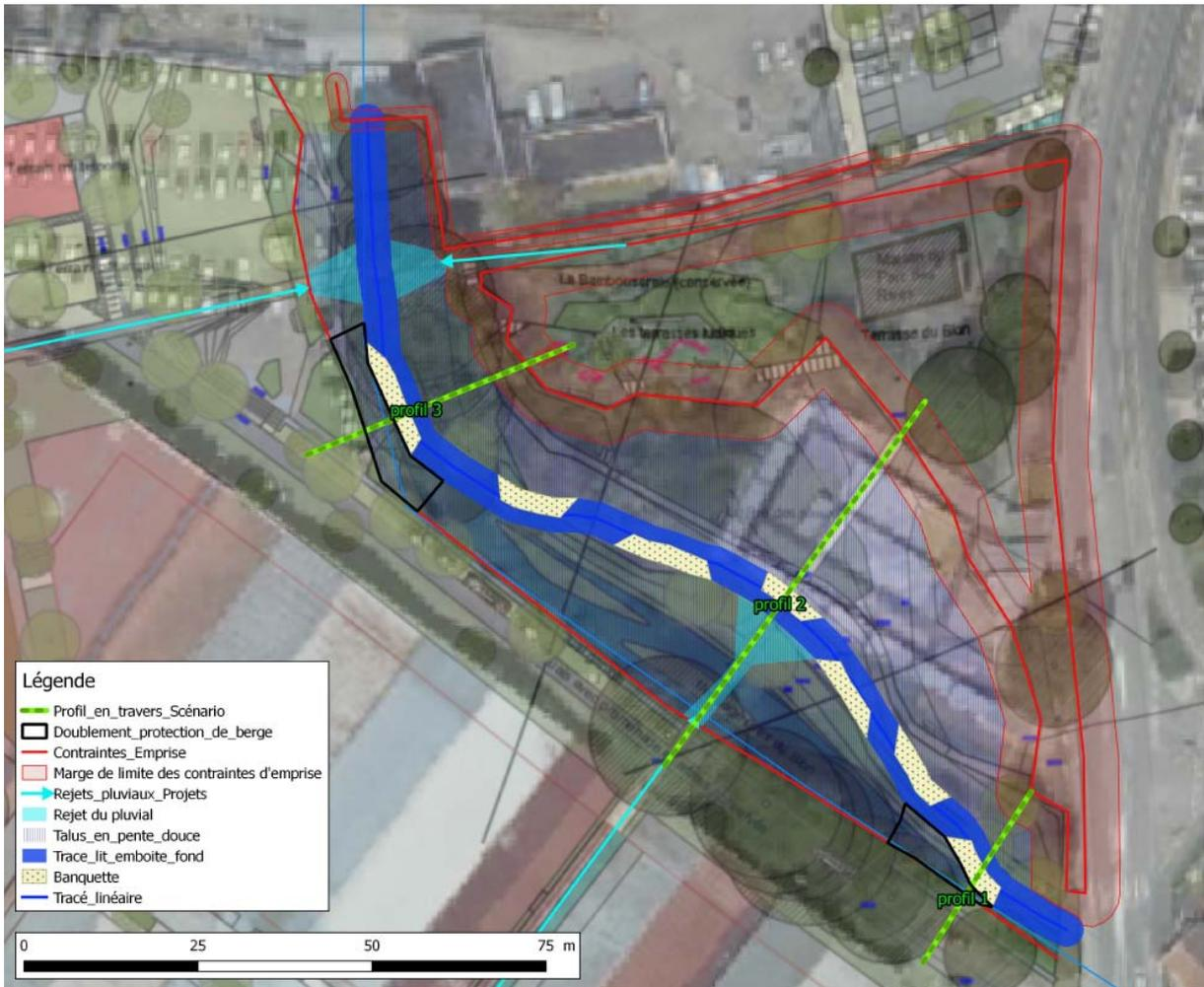
Figure 57 : Plan schématique du projet de restauration du Bion
