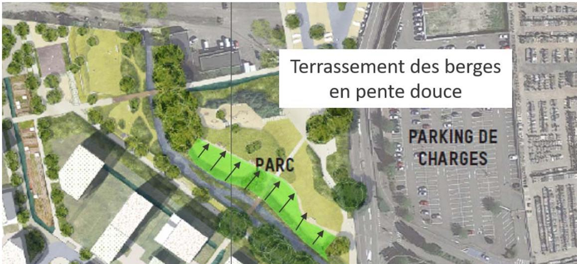
Figure 47 : Principe de re talutage de la berge en pente douce en rive droite de l'AVP de 2018
