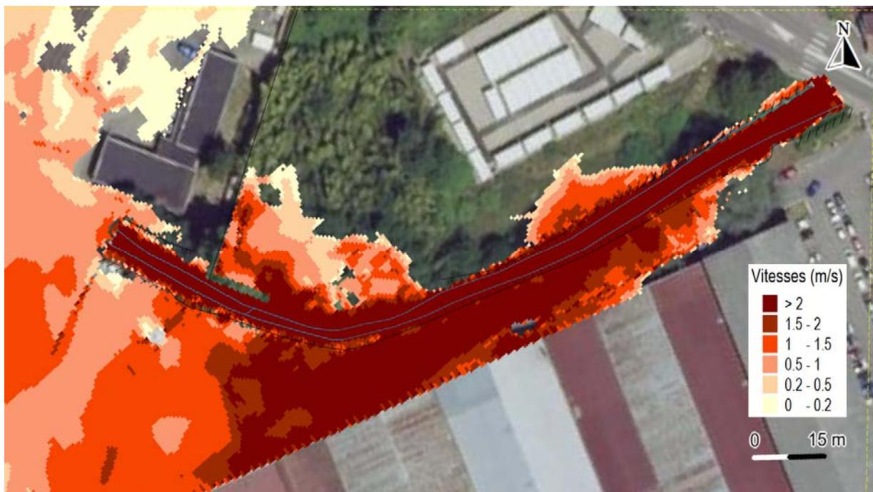
Figure 19 : Vitesses d'écoulement estimées en l'état actuel au niveau du projet de requalification – T = 100 ans (Q ~47 m<sup>3</sup>/s)
