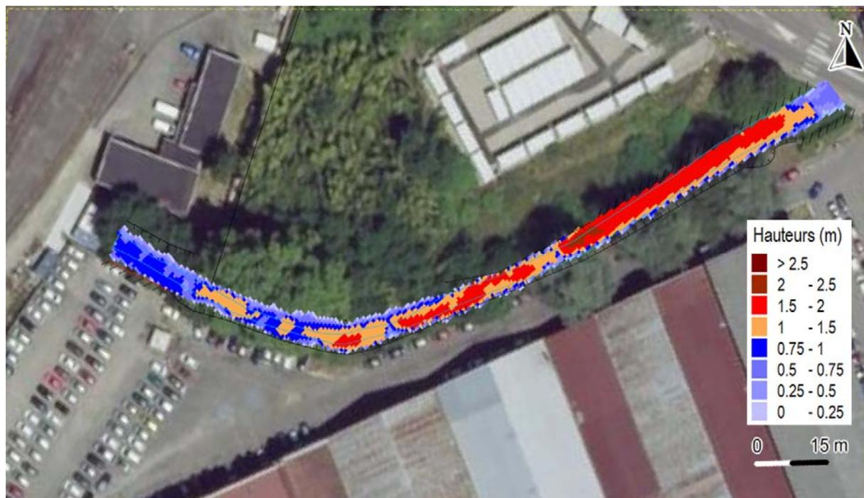
Figure 14 : Hauteurs de submersion estimées en l'état actuel au niveau du projet de requalification –  $Q = 9 \text{ m}^3/\text{s}$  (T-2 ans)
