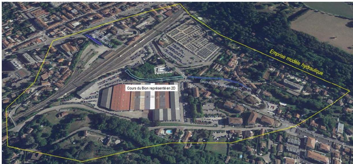
Figure 11 : Emprise d'analyse hydraulique avec indication des modes représentation du cours du Bion (1D ou 2D).
