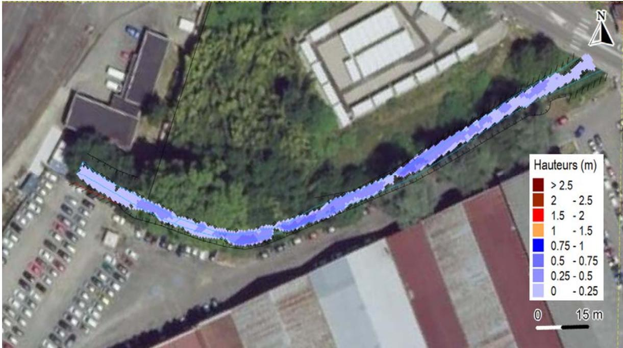
Figure 12 : Hauteurs de submersion estimées en l'état actuel au niveau du projet de requalification – Module
