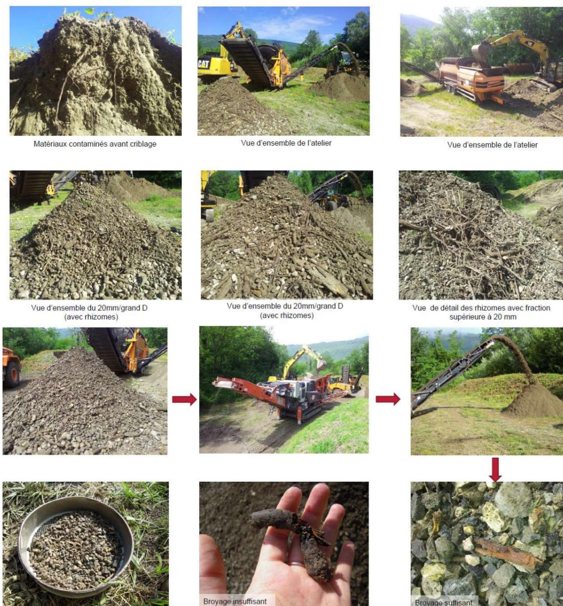
Figure 95 : Illustrations des expérimentations de la CNR de 2013/2014 pour le traitement de déblais impactés par la Renouée du Japon
