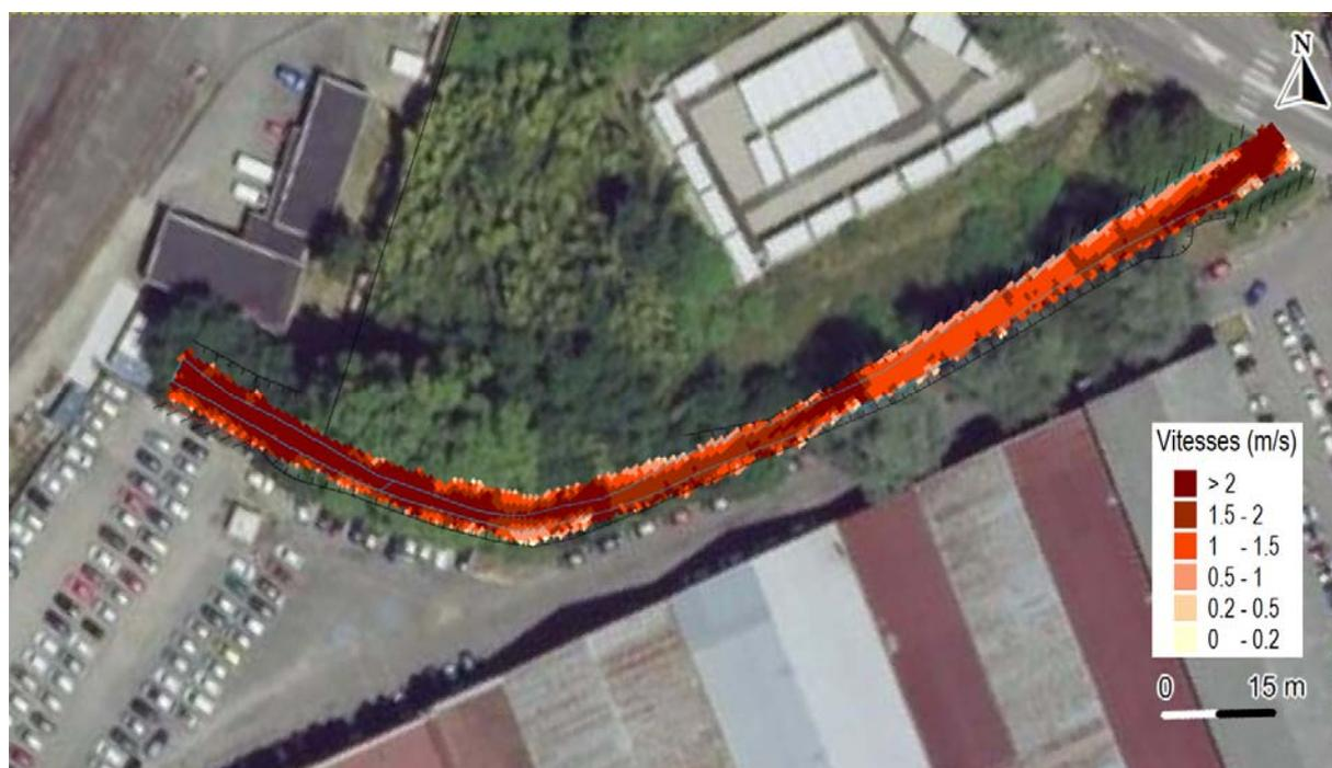
Figure 15 : Vitesses d'écoulement estimées en l'état actuel au niveau du projet de requalification –  $Q = 9 \text{ m}^3/\text{s}$  (T-2 ans)
