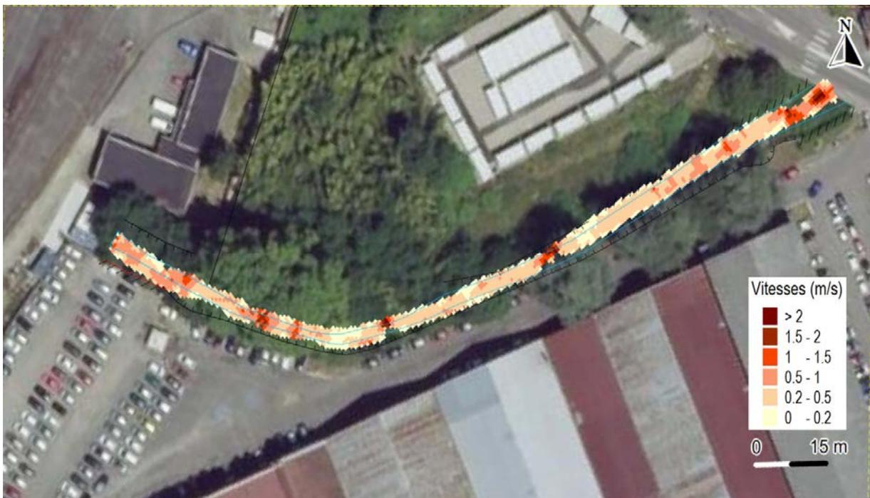
Figure 13 : Vitesses d'écoulement estimées en l'état actuel au niveau du projet de requalification – Module
