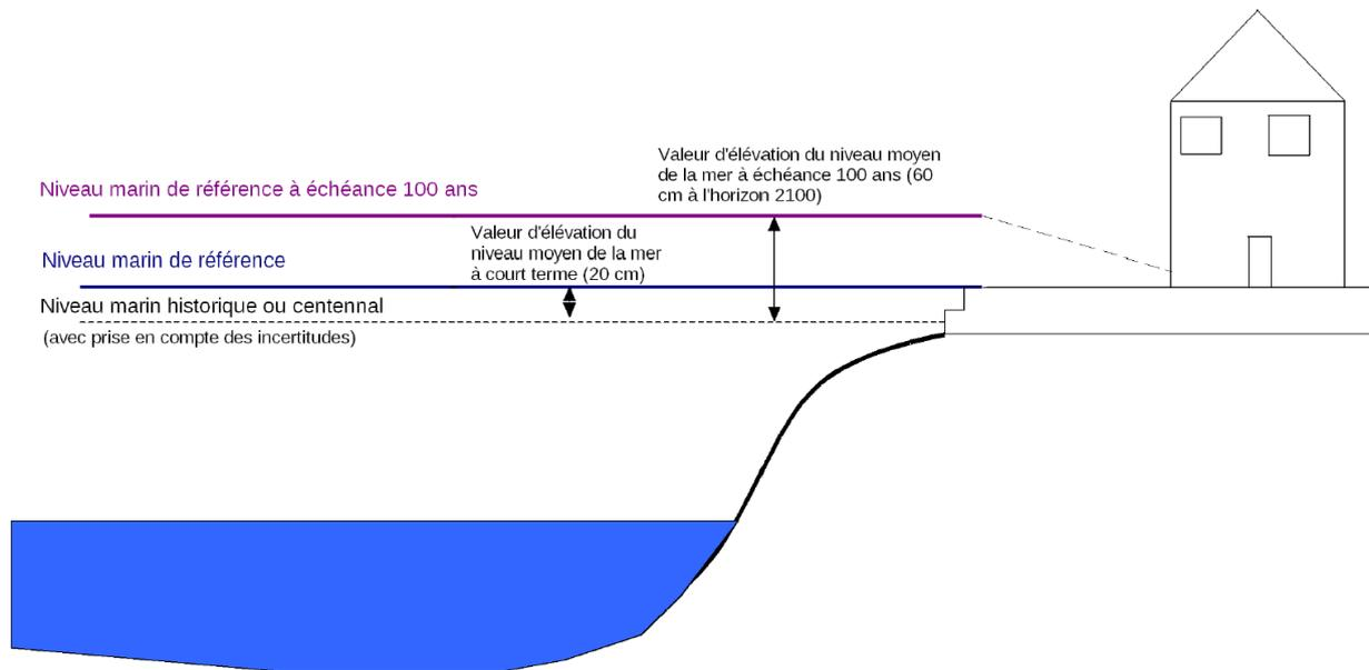
Figure 34 - Niveaux marins à prendre en compte pour la caractérisation de l'aléa submersion marine (DGPR, 2014)
