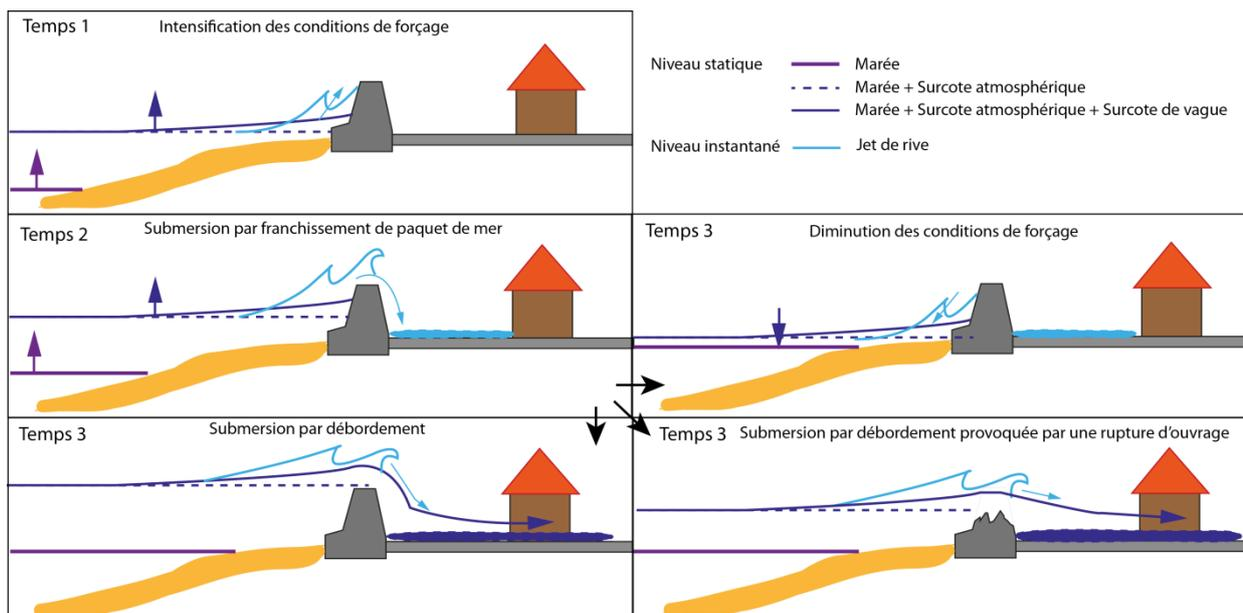
Figure 23 - Les différents types de submersion marine (Pedreros R. & Garcin M. 2012)
