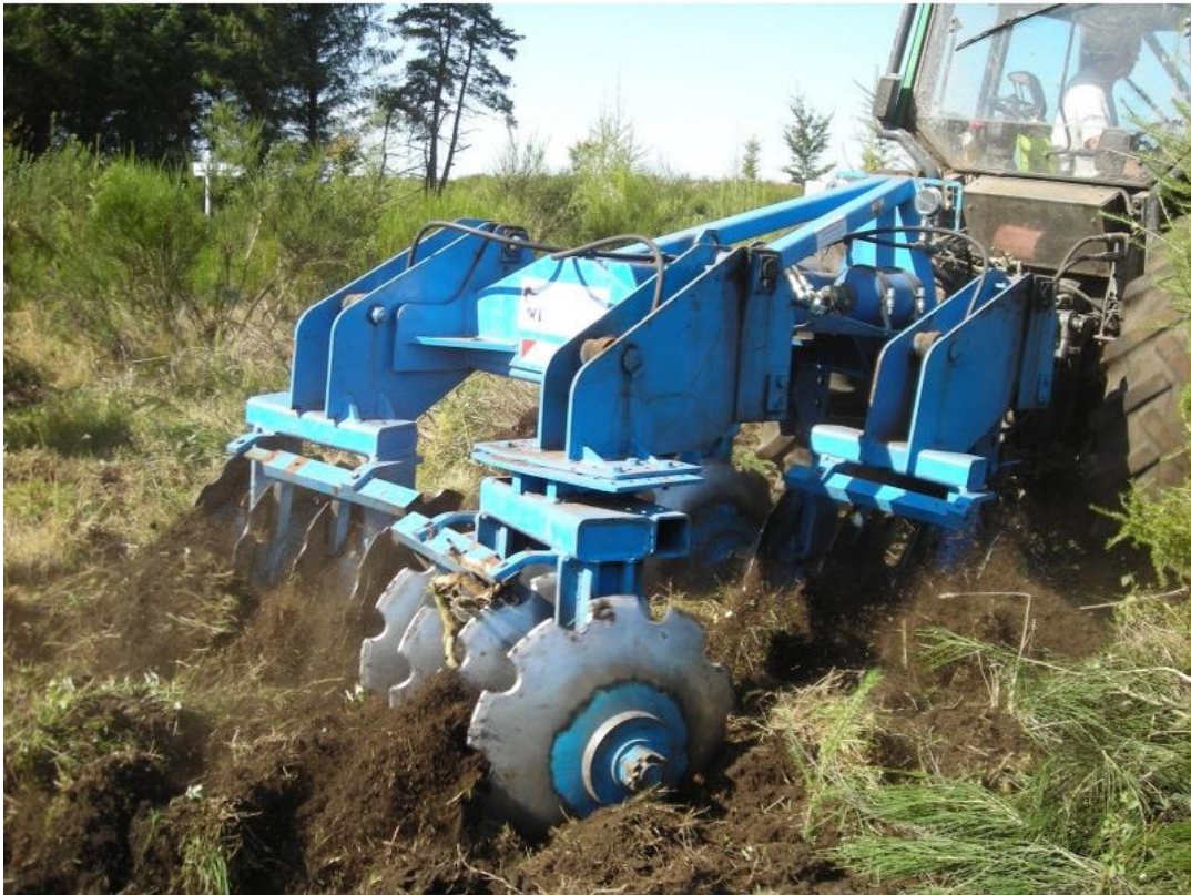
Scarificateur à disque « cover crop »
