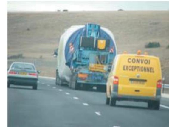
Photo 13 : Acheminement d'une nacelle par convoi exceptionnel jusqu'au chantier
