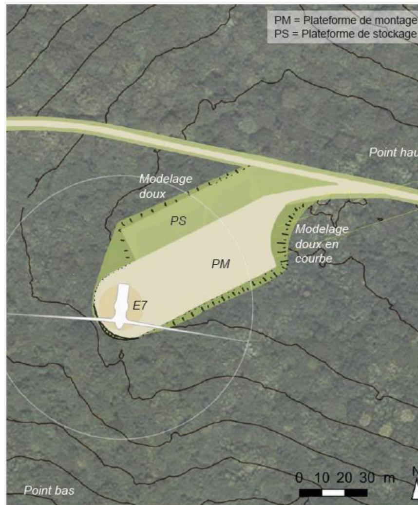
L'éolienne E7 se situe en espace boisé, sur une pente très douce en rebord de plateau. La plateforme de montage entoure et accueille l'éolienne. Autour des plateformes de stockage et de montage, les pentes sont modelées en douceur et étirées, les talus techniques gommés et reboisés.
