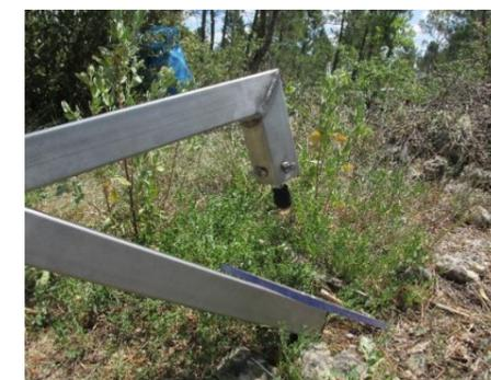
Photo 82 : Exemple d'un microphone monté sur un bras de déport pour équiper un mât de mesure
