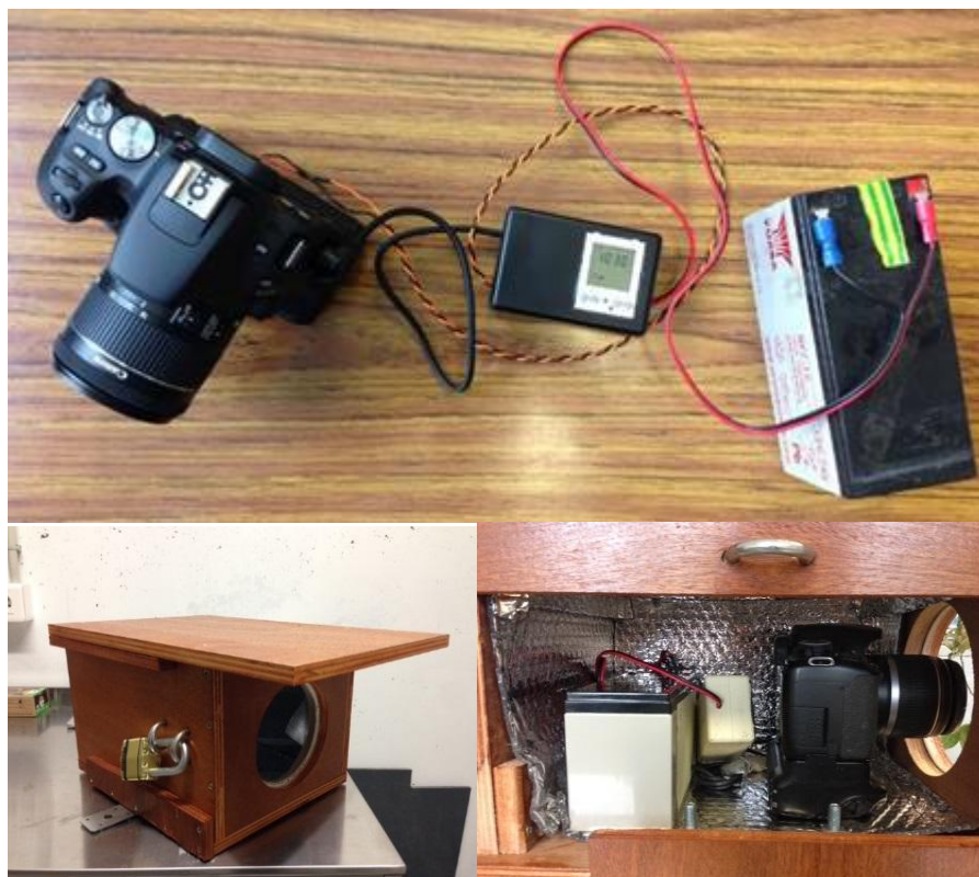
Figure 25. De gauche à droite : appareil photo et système de déclenchement électronique, caisson en contre-plaqué marine, appareil photo et son système de déclenchement électronique dans le caisson.
