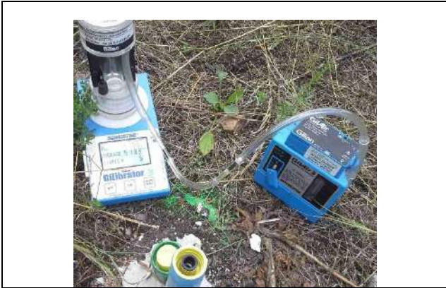
Photo 9 : Calibration du débit de pompage à 0,5l/mn
