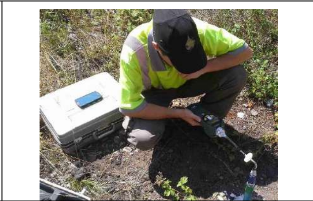
Photo 10 : Purge du piézair PzairB au PID
