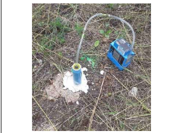
Photo 12 : Prélèvement du piézair PzairH – tubes support hopcalite montés en série
