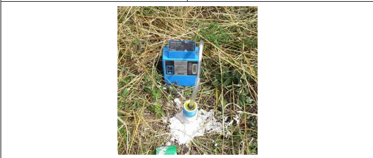
Photo 13 : Prélèvement du piézair PzairC – tube support XAD2
