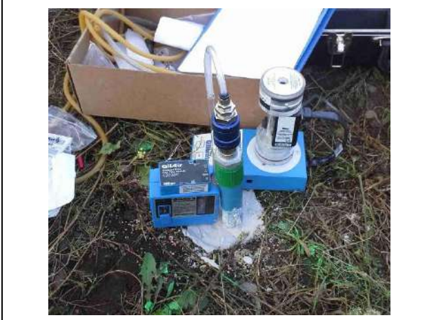
Photo 11 : Prélèvement du piézair PzairA – tube support TCA
