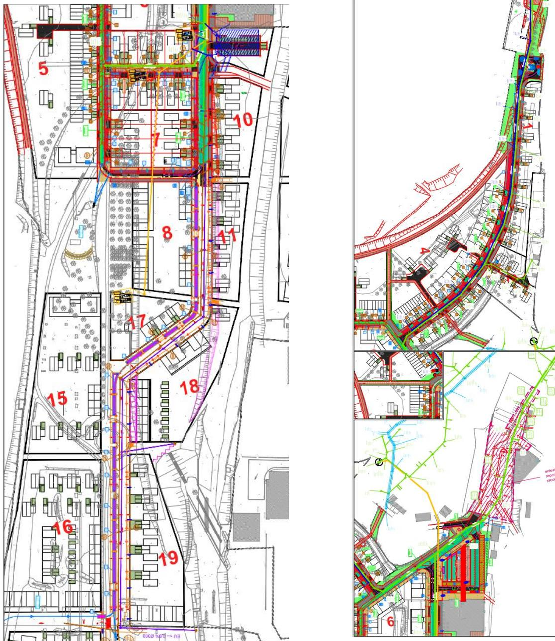
Figure 35 : Plan du réseau d'assainissement des Eaux Usées et Pluviales (Source : Infraservices)
