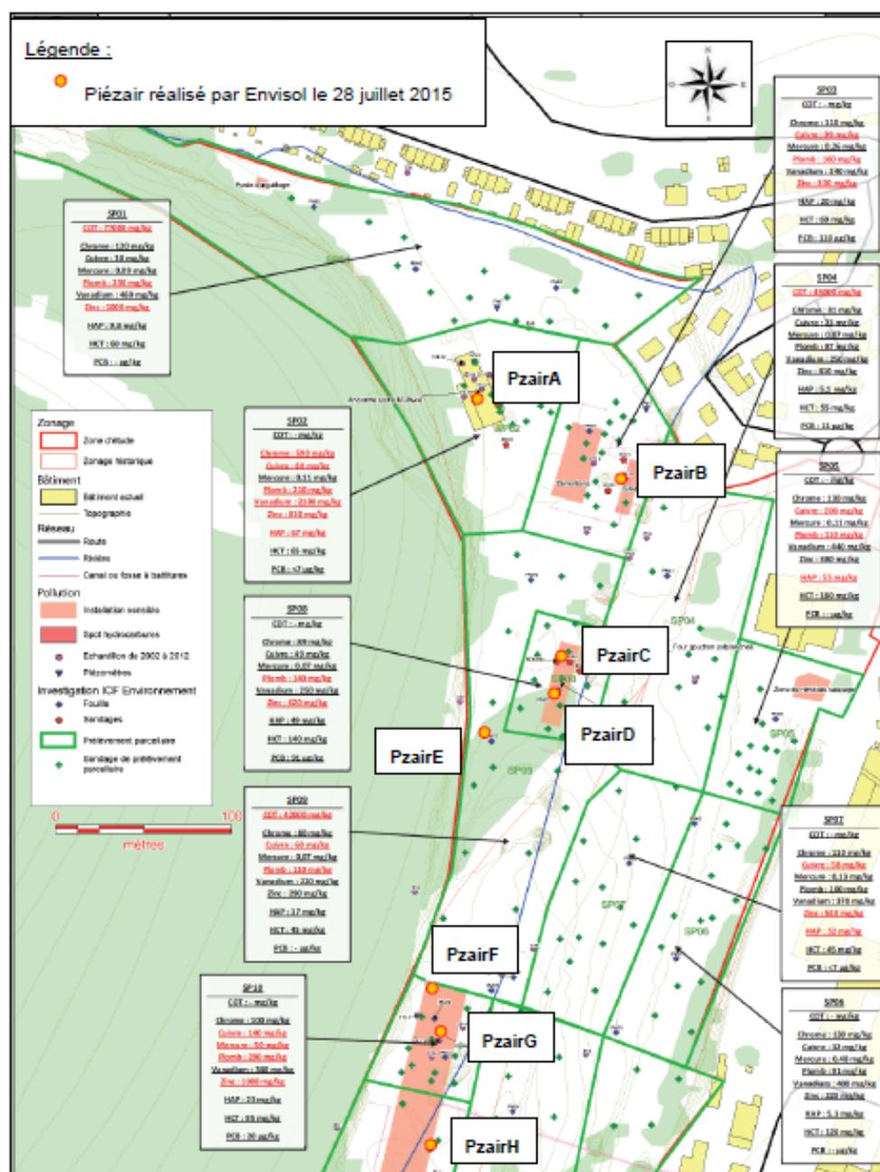
Figure 4 : Extrait de plan d'implantation des piézairs pour analyse des gaz de sol (Diagnostic environnemental, Envisol, juillet 2015)
