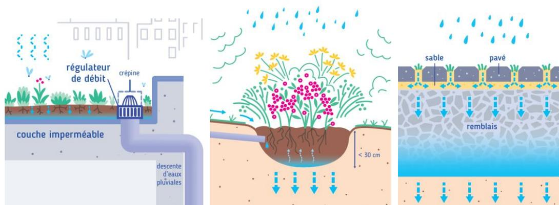
*Exemples d’aménagements multifonctionnels : toiture végétalisée, jardin de pluie, revêtement perméable*
