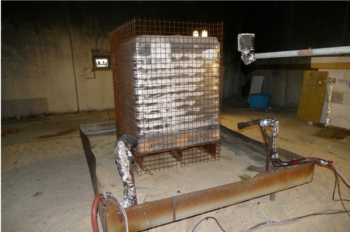
Figure 4 : Position des brûleurs servant à l'allumage de l'essai 1.
