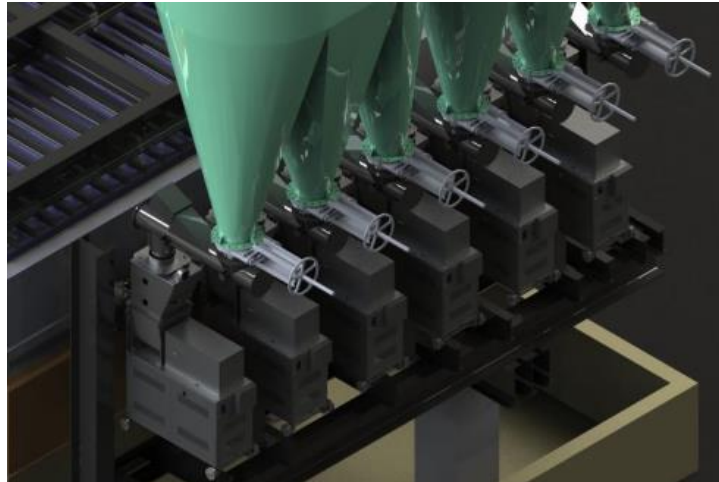
Figure 18 Système d'alimentation en matière première (source : Etude de pré-ingénierie Fives)
