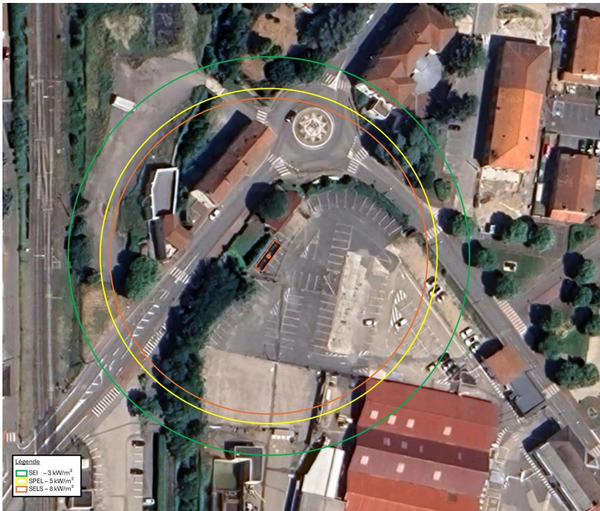
Figure 39 – Effets thermiques – Jet enflammé - serpent
