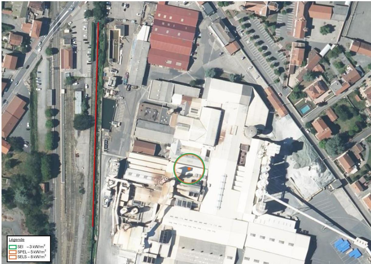
Figure 46 – Effets thermiques – UVCE – Four 3
