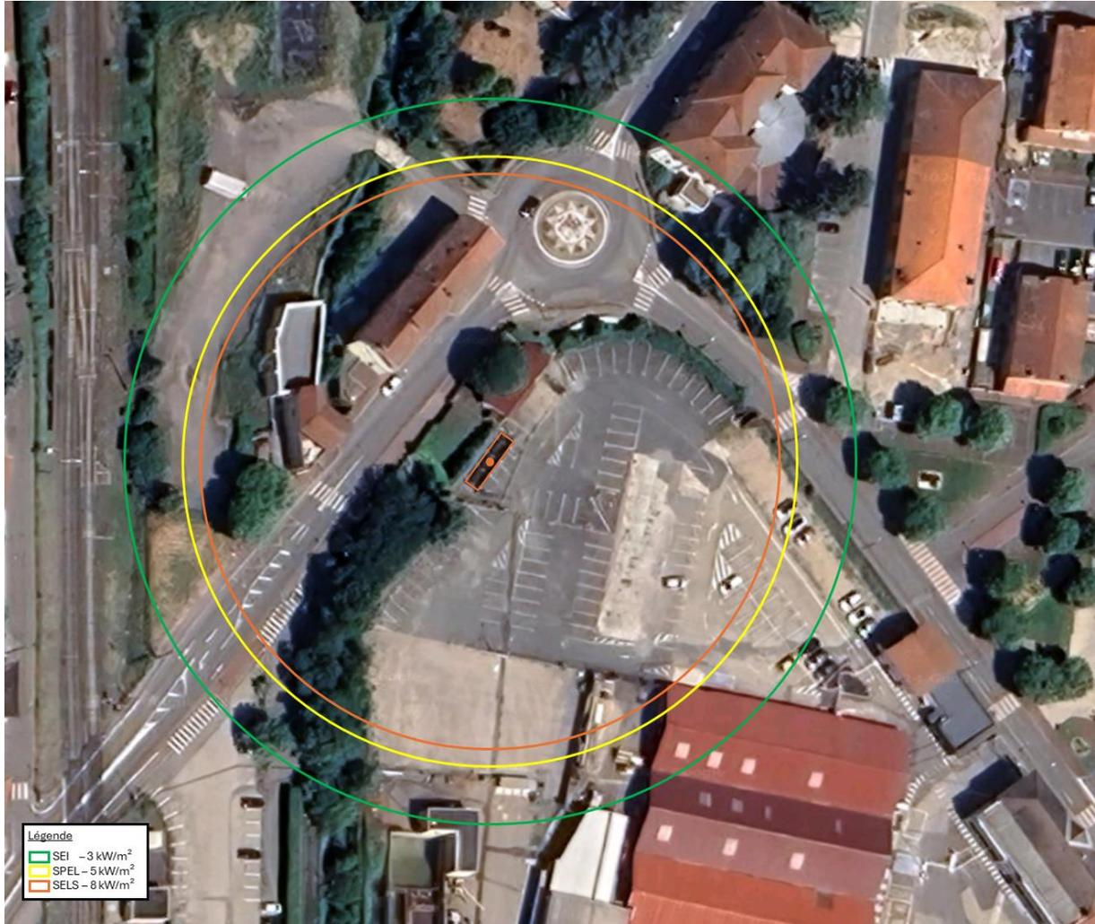
Figure 10 – Effets thermiques – Jet enflammé - serpentin
