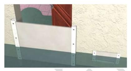
La stabilité des murs en maçonnerie de qualité courante peut être menacée dès lors que la différence de hauteur d'eau entre l'intérieur et l'extérieur atteint un mètre. Ceci conduit à limiter la hauteur des batardeaux à un mètre.
