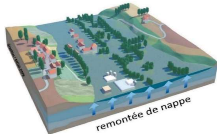
Figure 18 : Le phénomène d'inondation par remontée de nappe (Source : georisques.gouv.fr)
