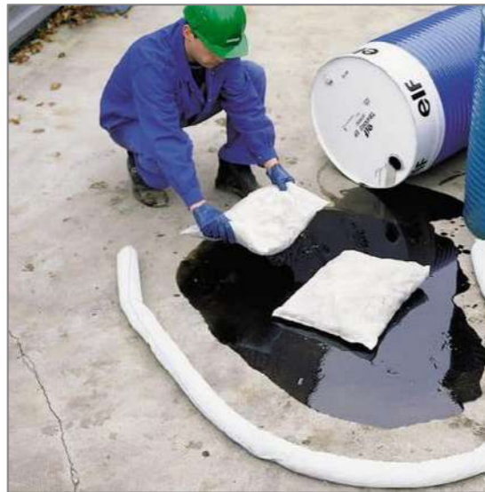
Photographie 51 : Kit anti-pollution utilisé sur une fuite d'hydrocarbures (Source : HALECO)
