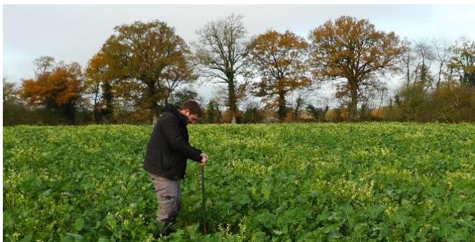
Prélèvement à l'aide d'une tarière pédologique © Calidris
