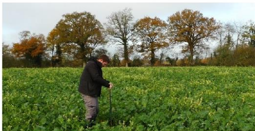
Prélèvement à l'aide d'une tarière pédologique © Calidris
