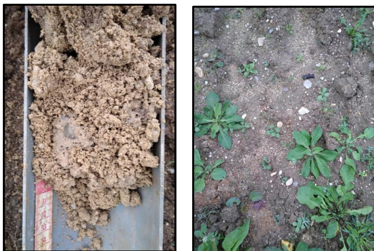
Figure 36. Pierrosité dans l'ANTHROPOSOL (photo 1) et en surface (photo 2) (Source : Prise de vue NCA)
