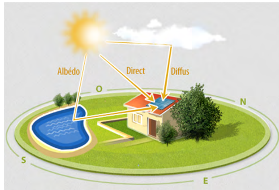
Figure 4 : Les 3 différents types de rayonnement solaire (source : Hespul)
