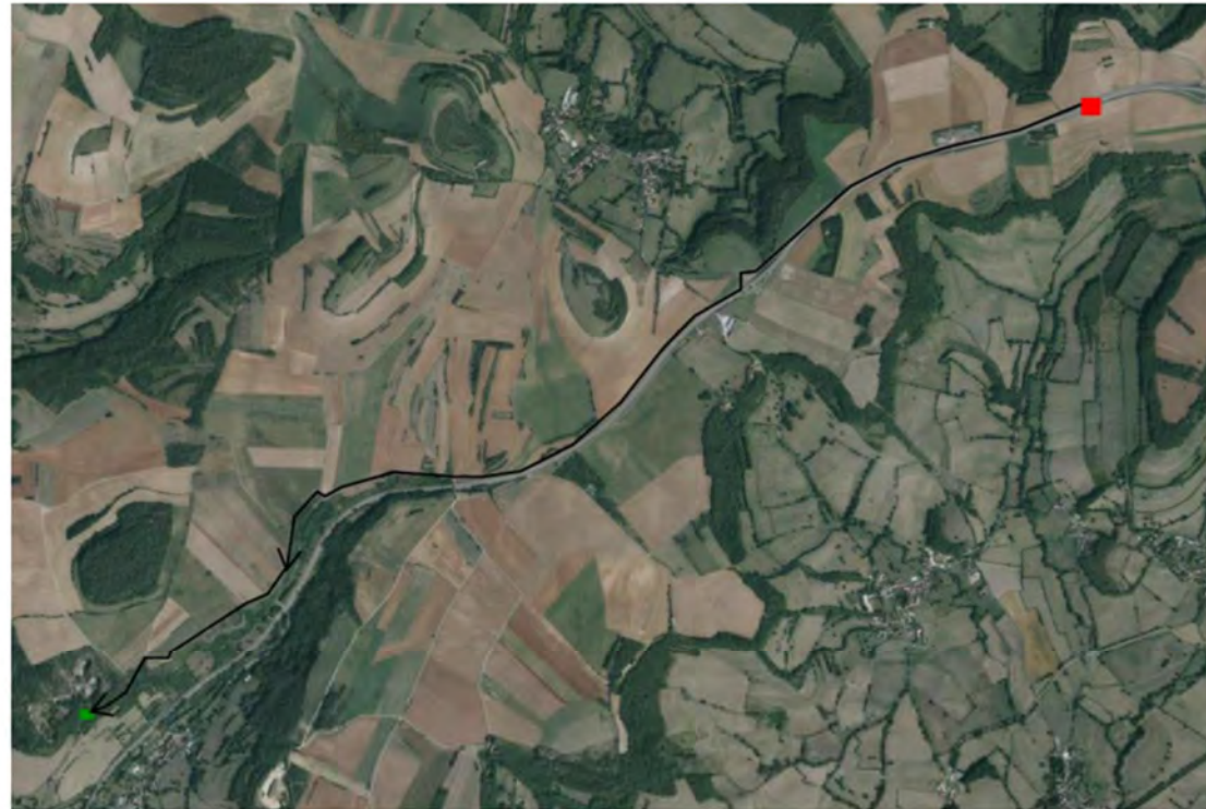
Point de raccordement sur réseau existant : ■ Projet Photovoltaïque CPES Larrey des Vignes : ■
