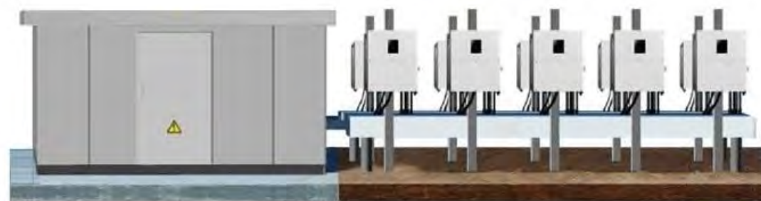
Figure 254 : Exemples d'onduleurs installés à l'extérieur et transformateur dans poste béton
