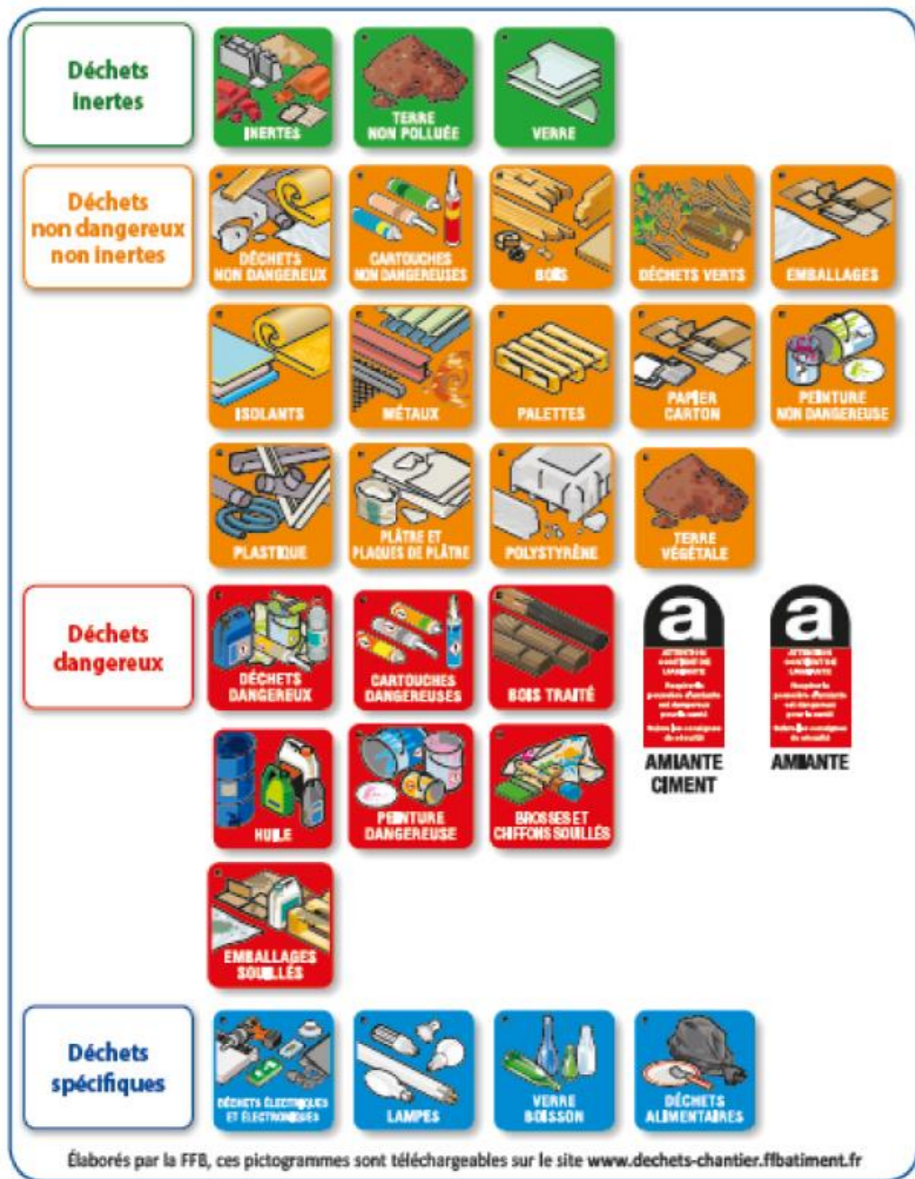
FIGURE 104 : EXEMPLES DE DÉCHETS ISSUS DES ACTIVITÉS DU BTP – LISTE NON EXHAUSTIVE (SOURCE : FF BÂTIMENT)
