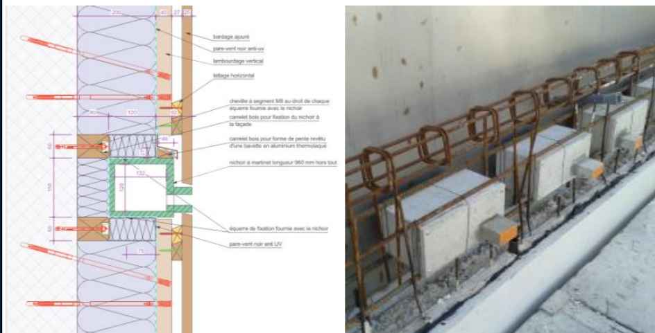
Figure 54- Principe d'installation de gîtes dans la structure et dans l'isolation d'un bâtiment (catalogue Nat'H)
