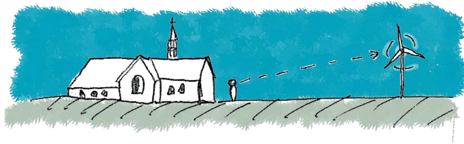
Figure 145 : Covisibilité indirecte, le monument et les éoliennes sont visibles dans un même champ de vision suivant un angle inférieur à 50°
