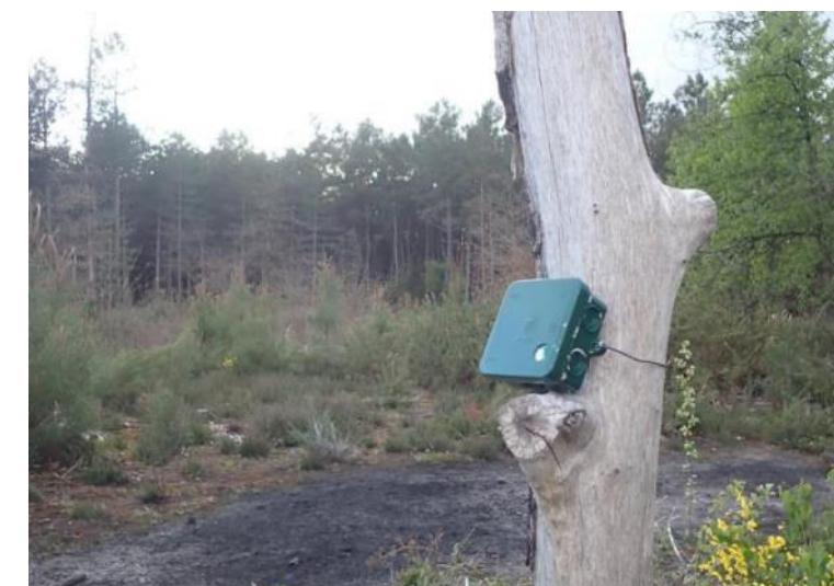
Figure 30. Exemple de point d'écoute avec un Audiomoth
