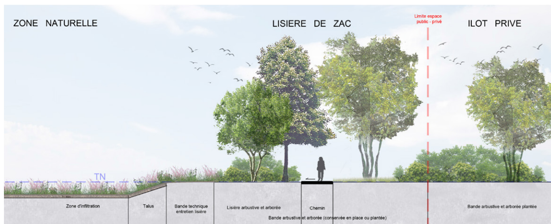
extrait de coupe montrant le décaissement maîtrisé pour la gestion des eaux pluviales dans la zone naturelle
