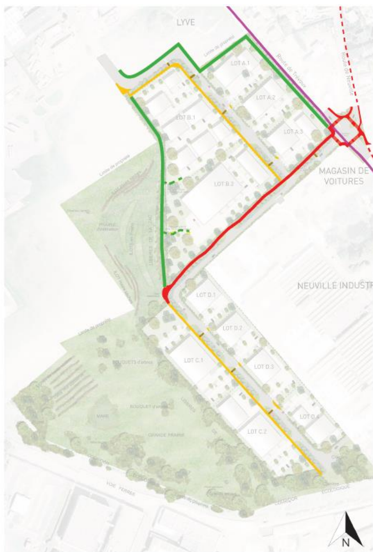
Schéma des circulations piétons vélos au sein de la ZAC
