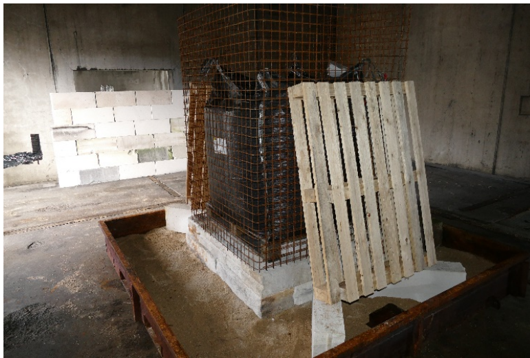
Figure 10. Disposition du stockage de charbon actif et des palettes en bois lors de l'essai Flumilog
