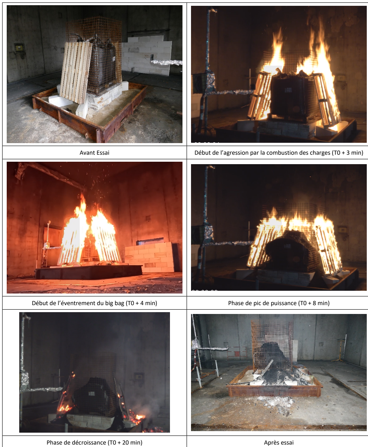
Figure 12. Déroulé de l'essai n°3 pour le big bag de charbon actif. Dans les légendes des photographies, T0 fait référence au démarrage de l'agression
