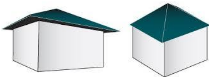
Toiture à 4 pans
