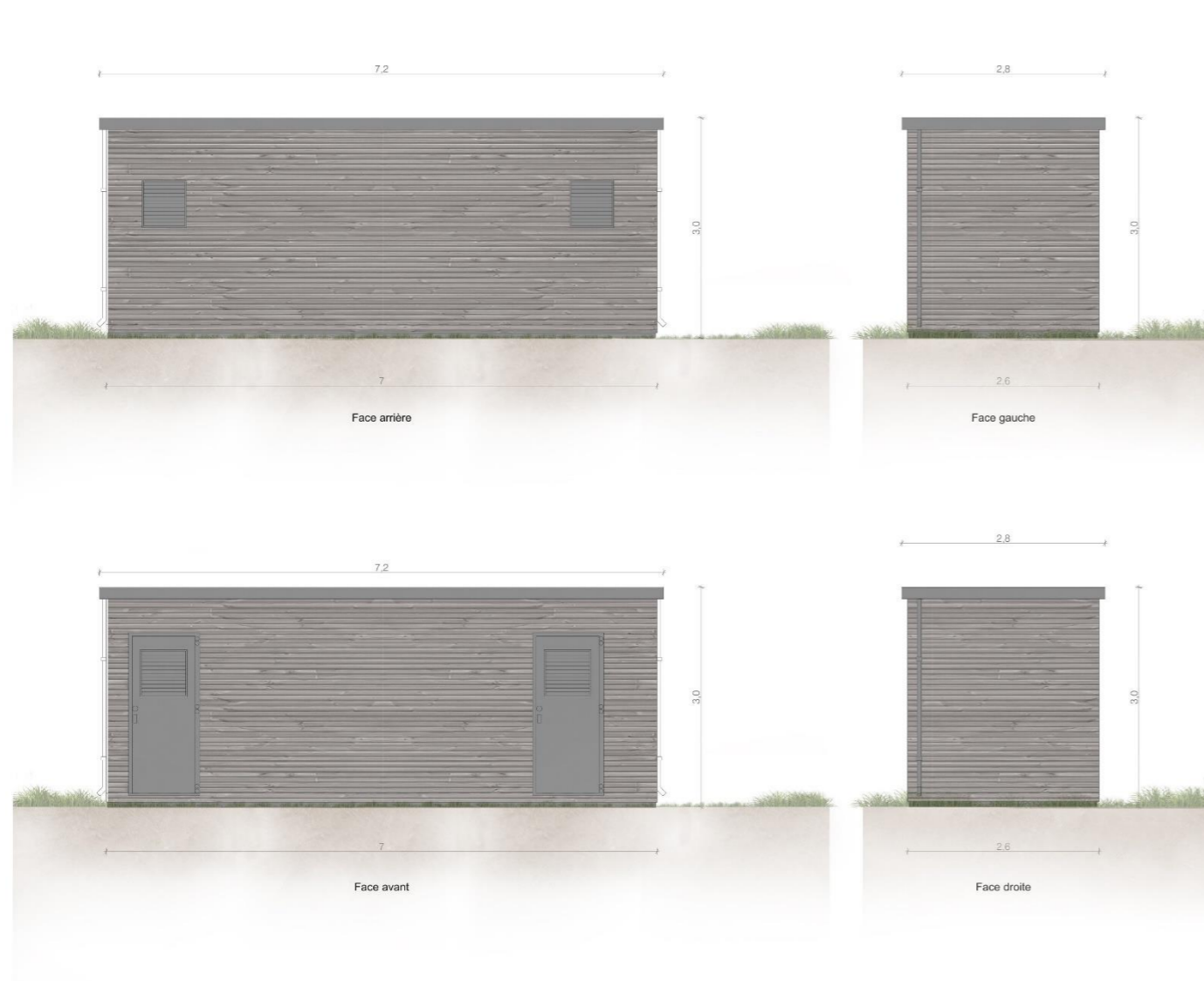
Figure 23 : Poste de livraison
