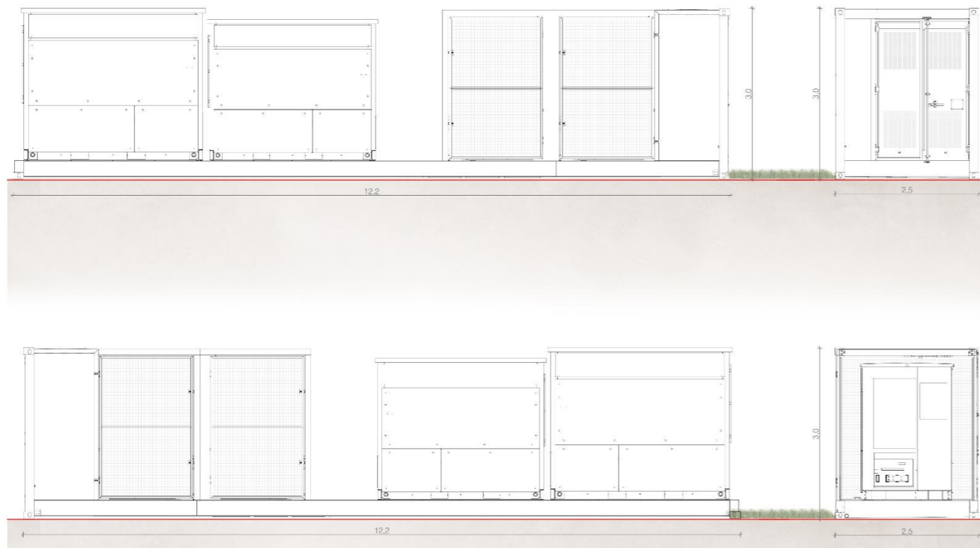
Figure 19 – Coupes d'un poste de transformation (source : PHOTOSOL)
