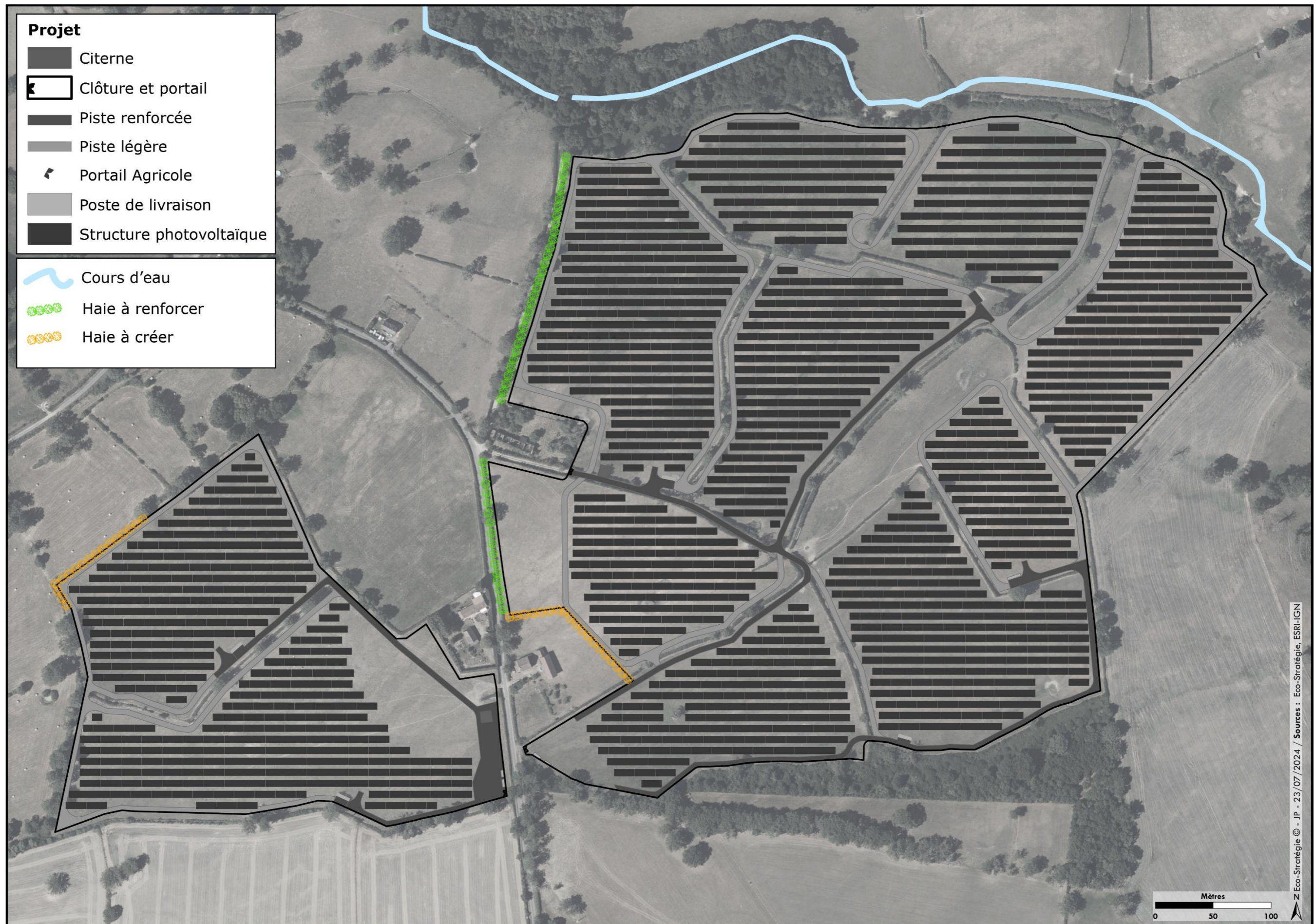
Figure 3 : Plan de masse du projet et localisation de la mesure R2-2K
